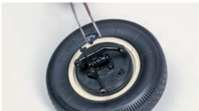
Поместите буфер хода отбоя на дополнительную ось стойки передней подвески. Деталь должна плотно сесть на ось и держаться за счет трения. При необходимости зафиксируйте деталь с помощью клея.
