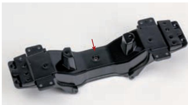
Соберите поперечину рамы №2 (подмоторную балку). Для этого накройте поперечину накладкой и закрепите детали по центру при помощи винта 2,0×5 (СМ).
