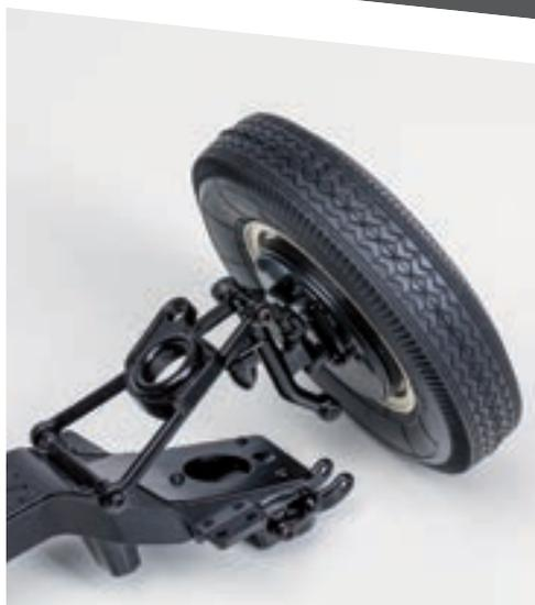
Поместите нижнюю часть стойки передней подвески между ранее установленными нижними рычагами. Совместите крепежные отверстия и закрепите детали между собой винтом 2,0×11,5 (EM).
