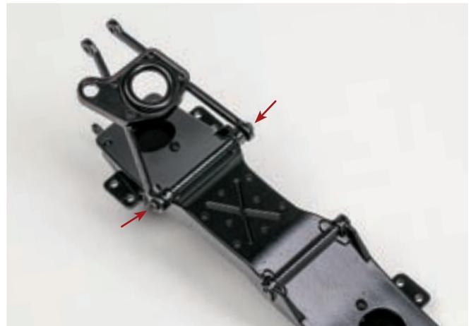
Установите и закрепите на нижней стороне поперечины собранные нижние левые рычаги передней подвески. Проушина крепления стойки стабилизатора на рычагах должна быть расположена в его передней части. Для фиксации детали используйте два винта 2,0×5 (СМ). Рычаги должны оставаться подвижными относительно поперечины.
