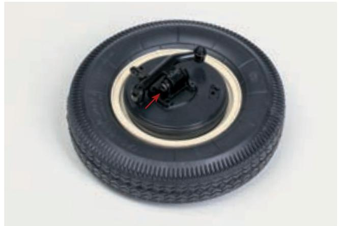
Поместите стойку передней подвески в поворотную ось кулака переднего левого колеса. Обратите внимание: верхняя часть стойки загнута в сторону колеса. Закрепите деталь винтом 2,0×11,5 (EM) с нижней стороны поворотного кулака. По окончании проверьте подвижность стойки относительно поворотного кулака, при необходимости ослабьте крепеж.
