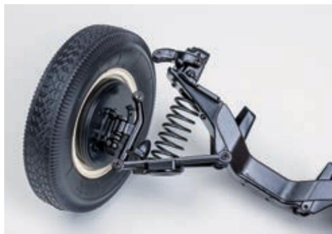
Установите пружину нижним концом на площадке между нижними рычагами, а верхним концом вставьте ее в углубление поперечины рамы.
