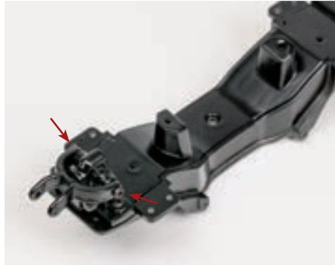
Двумя винтами 2,0×5 (СМ) закрепите верхний левый рычаг на корпусе установленного ранее амортизатора. Обратите внимание: опорные площадки буферов хода отбоя на верхнем рычаге располагаются на его нижней плоскости.
