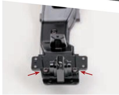
На левую верхнюю часть поперечины установите корпус левого амортизатора. При правильной ориентации подмоторной балки ее центральная часть изгибается вперед и вниз по ходу движения модели. Закрепите амортизатор двумя винтами 2,0×5 (СМ).
